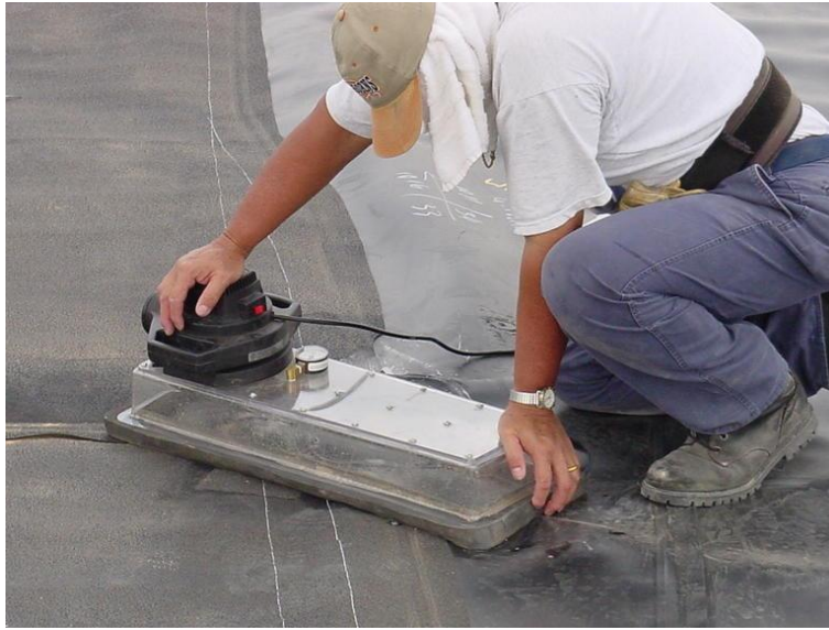
Figura 19: Realización de pruebas de caja de vacío
