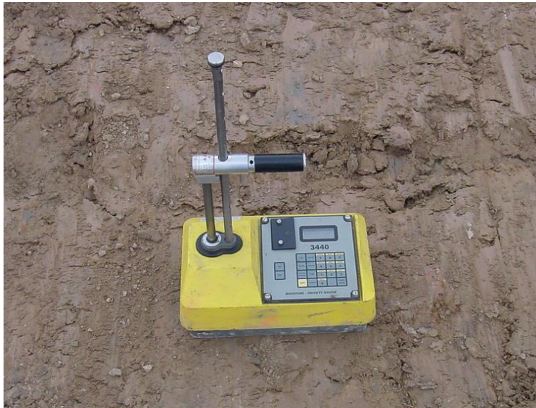
Figura 11: Calibración nuclear de densidad
