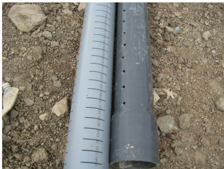
Figura 28: Tuberías de recolección de lixiviados ranuradas y perforadas
