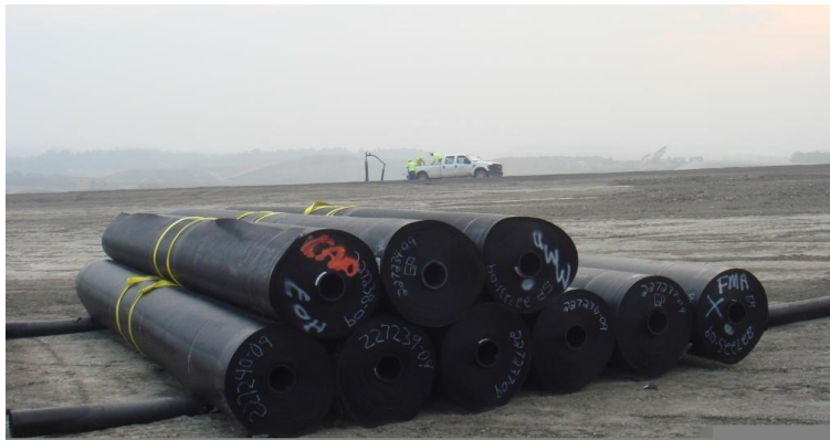
Figura 12: Rollos geosintéticos de recubrimiento de HDPE almacenados adecuadamente
