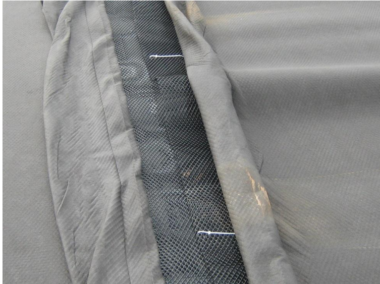
Figura 26: Geocompuesto con geored y geotextil
