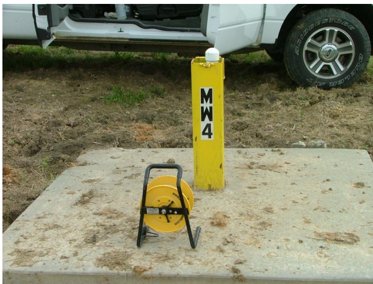
Figura 39: Pozo para el monitoreo de aguas subterráneas
