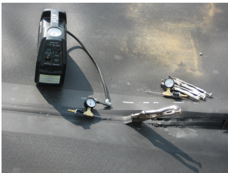
Figura 18: Pruebas de presión de aire en selladuras soldadas por puntos
