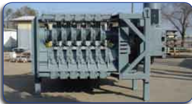
Figura 6-3. Trituradora de llantas con cuchillas espaciadas 6 pulgadas. Foto cortesía de Barclay Roto-Shred Inc, Stockton, California
