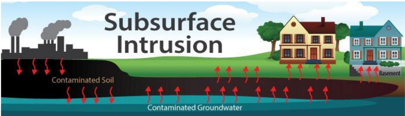
La figura anterior ilustra un modelo conceptual de intrusión subterránea, que es una migración de sustancias peligrosas, contaminantes o contaminantes de zonas no saturadas o aguas subterráneas poco profundas a estructuras suprayacentes a través de sumideros y/o grietas. Las sustancias peligrosas que genera una instalación contaminan el suelo subterráneo y las aguas subterráneas, y luego migran a los edificios.
